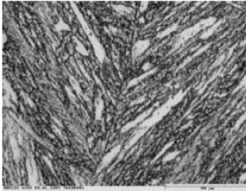
Рис. 2. Микроструктура мартенситной стали [11]
