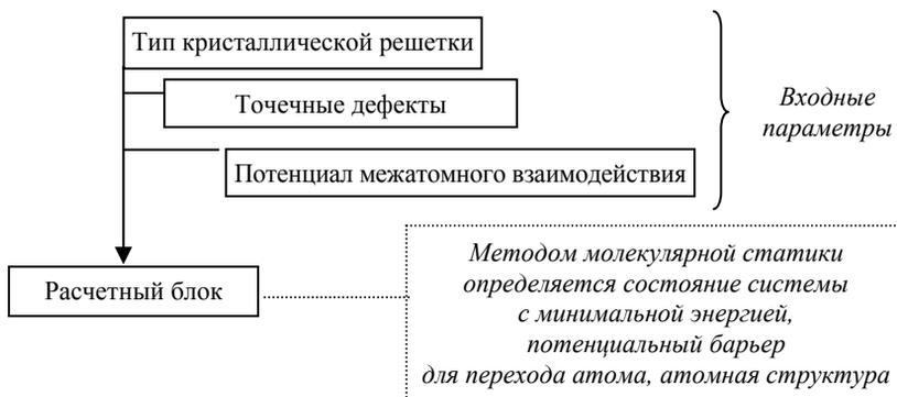
Рис. 1. Блок-схема программного комплекса для расчета энергетических характеристик комплексов дефектов  $m$ -атомов водорода –  $n$ -вакансий
