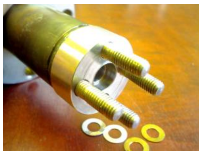
Рис. 3. Ячейка для экспериментов по водородопроницаемости циркониевого сплава
