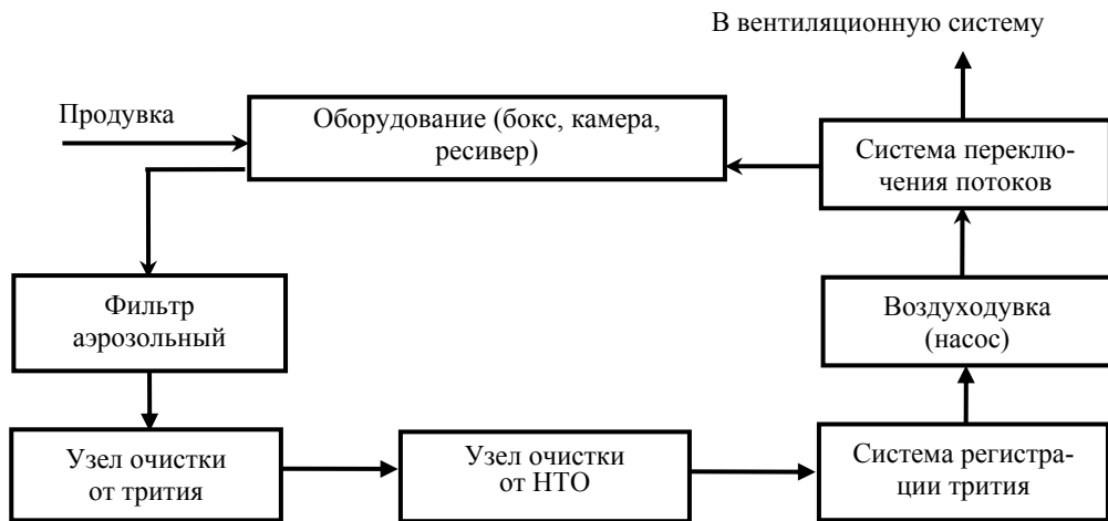
Рис. 1.1. Схема очистки газообразных выбросов от трития
