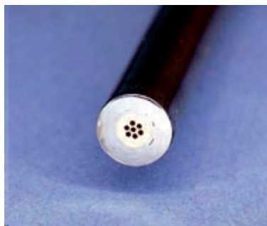
Рис. 3. Схема «six-around-one» расположения волокон оптического зонда «Avantes»
