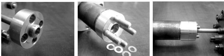
Рис. 2. Конструкция ячейки для экспериментов по водородопроницаемости
