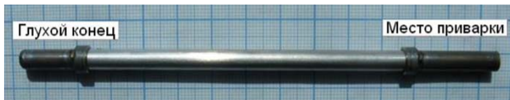
Рис. 2. Образец трубчатой мембраны из двойного ОЦК сплава ванадия с палладиевым покрытием внешней и внутренней сторон (для наглядности на фотографии представлен образец мембраны более короткой, чем использованная в данном эксперименте)
