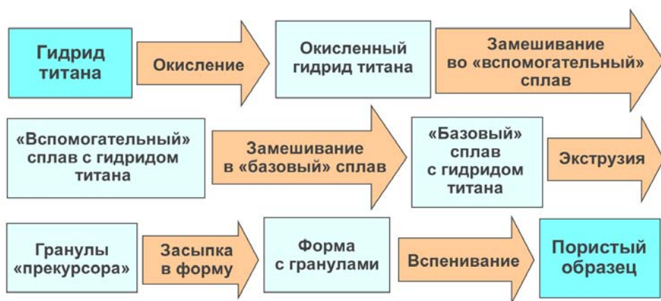
Рис. 6. Схема получения образцов из алюминиевой пены с использованием \text{TiH}_2 , разработанная сотрудниками РФЯЦ-ВНИИЭФ и ОАО «ВИЛС»
