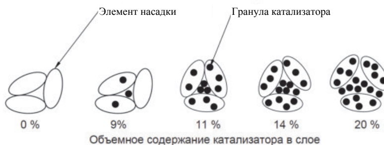
Рис. 6. Визуализация изменения решетки нерегулярной насадки с изменением объемной доли катализатора
